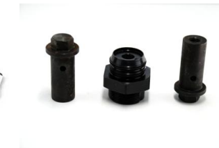
机加工—热处理—发黑—绉磨—铆销材质1215
